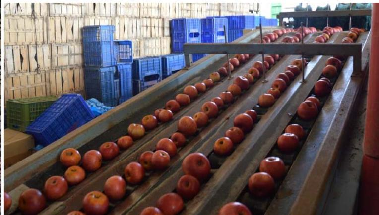
Nastro trasportatore che conduce le mele sulla pesatrice, calibrata con un programma elettronico
